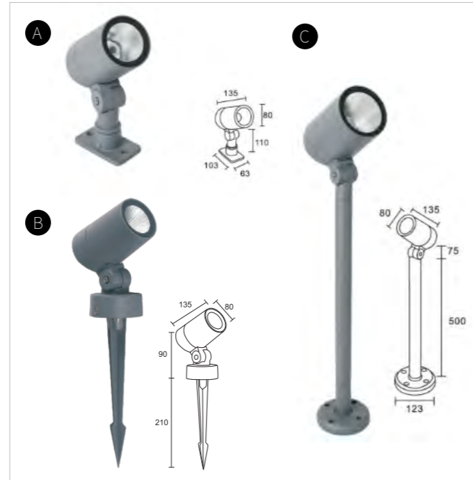
CT-61602 光源：E27*2(另計) 電壓：100V~220V 燈體材質：壓鑄鋁(砂黑烤漆) 防護等級：IP65
