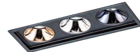
CT-60555 光源：A~I 材質：鋁製品 尺寸：L163mm W61mm H95mm 顏色：□White ■Black 嵌入孔 55x155mm
