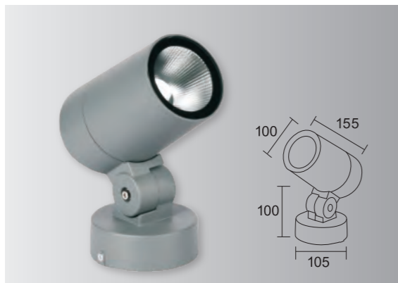
CT-61604 瓦數：20W 材質：鋁製品 色溫：3000K/4000K/5700K 角度：25° /60° 電壓：12V/24V/110V~220V 防護等級：IP65
